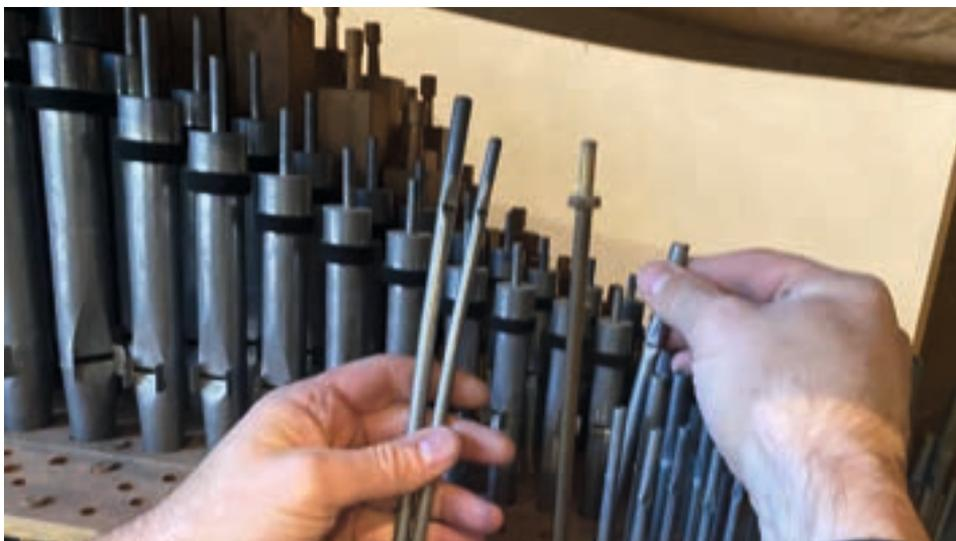
Die Pfeifen werden für den langen Transport einzeln ausgebaut.
